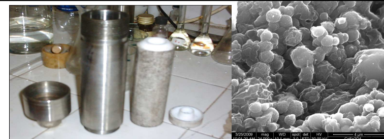
Autoclavă de teflon prevăzută cu manta de oțel pentru obtinerea feritelor de cobalt prin metoda solvotermala
